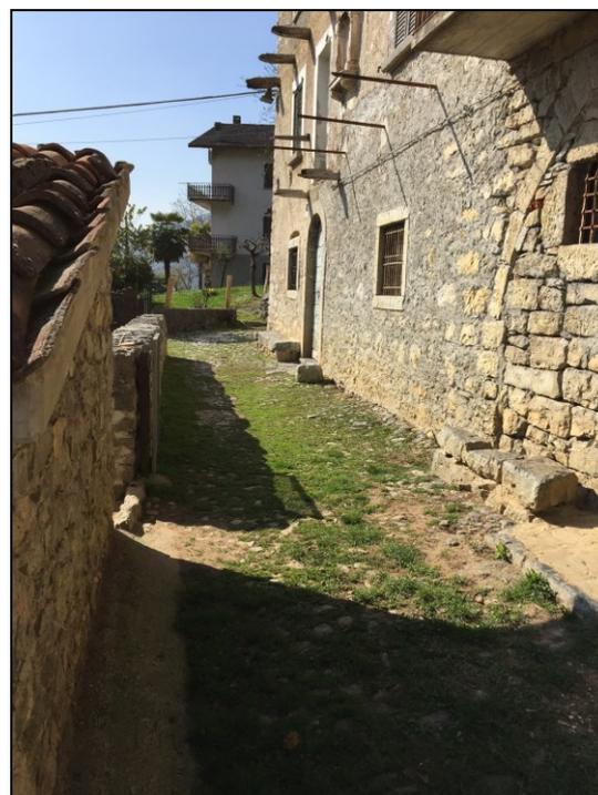
**Foto 3:** il pendio a valle dell'edificio ha una inclinazione molto bassa, che via via tende a crescere, e risulta rimodellato da interventi antropici, con presenza di stradine, terrazzamenti e muretti a secco
