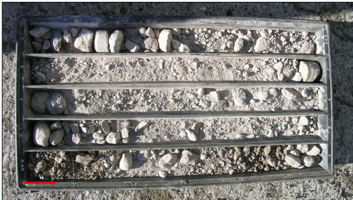
Foto A1.11 - Sondaggio n.3 (Interc. Nord): profondità 0,00m-5,00m.
