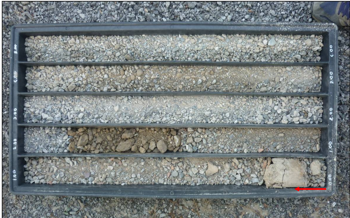
Foto A1.2 - Sondaggio n.1: profondità 0,00m-5,00m.
