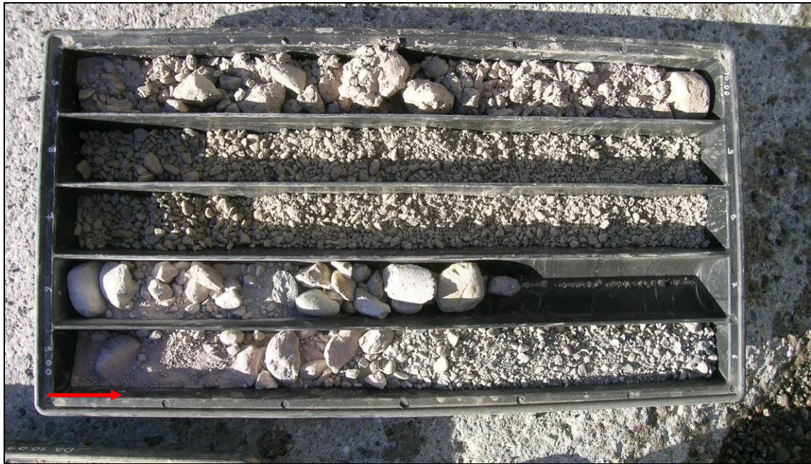
Foto A1.12 - Sondaggio n.3 (Interc. Nord): profondità 5,00m-10,00m.
