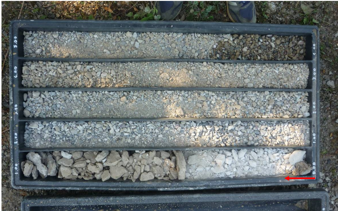
Foto A1.7 - Sondaggio n.2: profondità 0,00m-5,00m.
