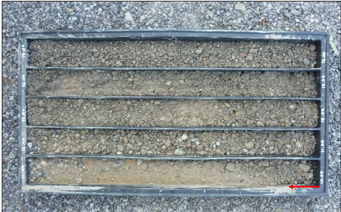
Foto A1.4 - Sondaggio n.1: profondità 10,00m-15,00m.
